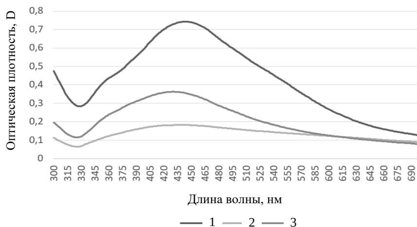
Рисунок – Спектрограммы поглощения растворов наночастиц серебра, полученных различными методами синтеза: 1 – «зелёный» синтез, 2 – цитратный метод, 3 – борогидридный метод
