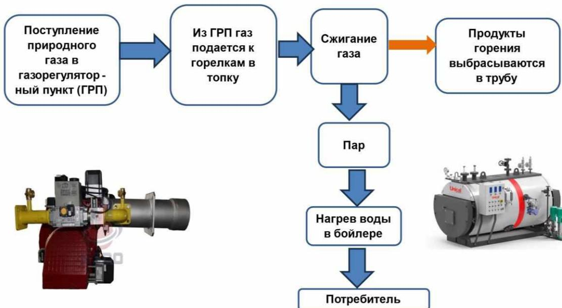
Рис. 5. Технология производства тепловой энергии в котельной № 56, работающей на газе
