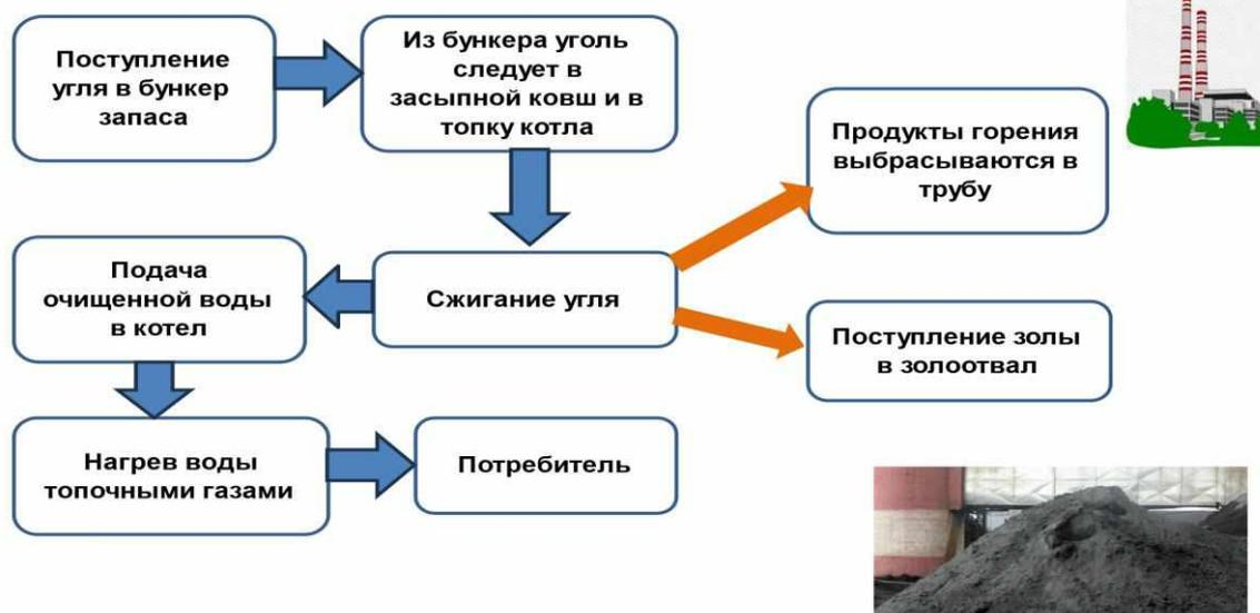
**Рис. 4.** Технология производства тепловой энергии в котельной № 41, работающей на угле
