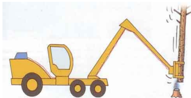
Рис. 2. Захват и срезание дерева
