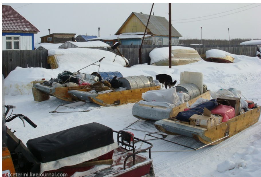
Рис. 1. Конструкция саней-волокуш для перевозки груза
