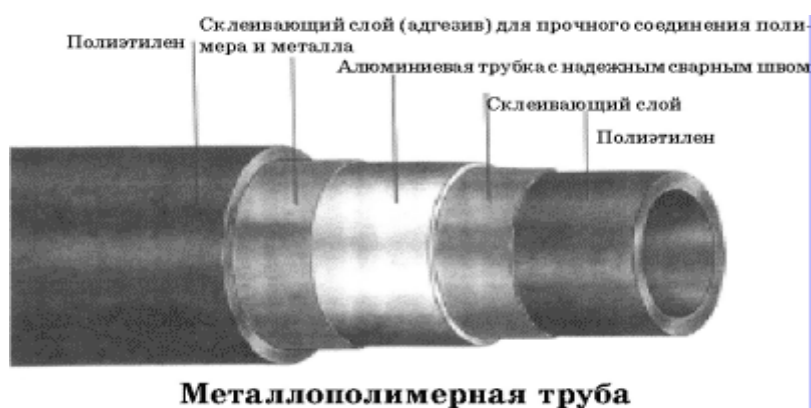
Рис. 4. Схема металлополимерной трубы
