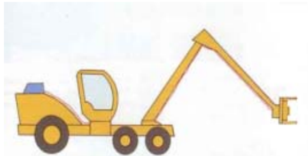
Рис. 1. Наведение харвестерной головки на дерево
