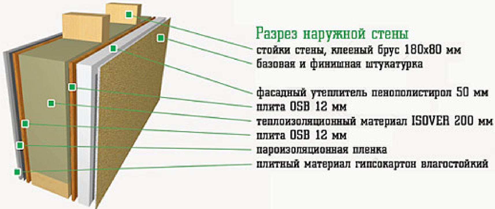
«Немецкая» технология каркасно-панельного домостроения – наиболее технологичная и индустриализированная из всех известных в настоящее время. Так, на заводах-автоматах фирмы Weinmann каркас дома на 90 % собирается в теплых сухих цехах по специальной программе.
