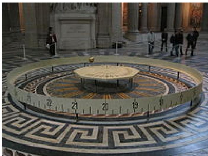
Период колебания маятника при такой длине подвеса составлял 16,4 с, при каждом колебании отклонение от предыдущего пересечения песчаной дорожки составляло  $\sim 3$  мм, за час плоскость колебаний маятника повернулась более чем на  $11^\circ$  по часовой стрелке, т. е. примерно за 32 часа совершила полный оборот и вернулась в прежнее положение.
