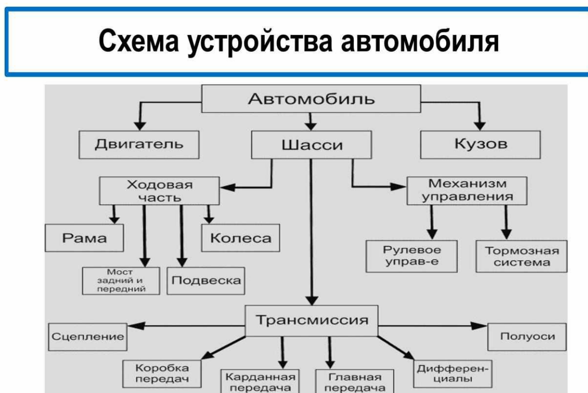
Рис. 2. Конструкционные элементы автомобиля
