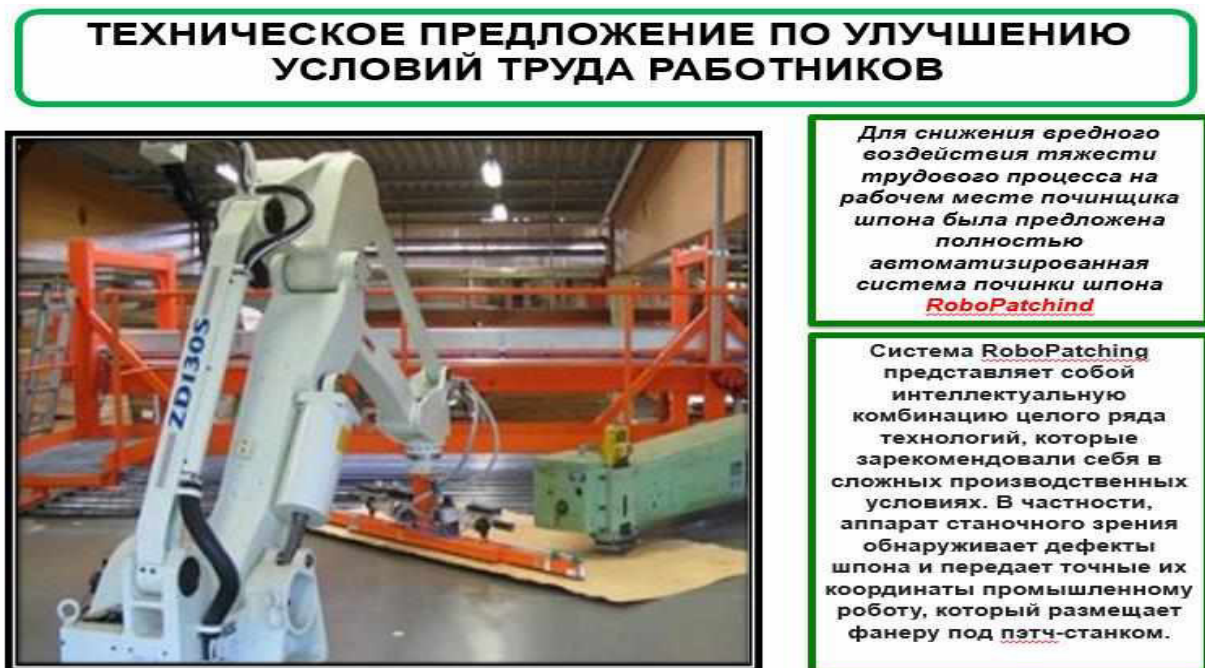
Рис. 12. Система RoboPatching для починки шпона
