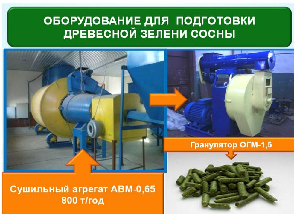
**Рис. 4.** Оборудование для сушки и грануляции древесной зелени при получении хвойно-витаминной муки
