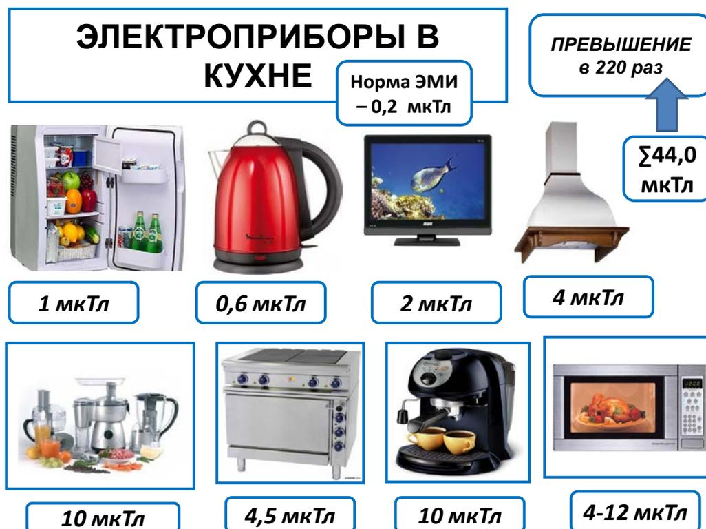
Рис. 7. Результаты измерений ЭМИ кухонных электроприборов
