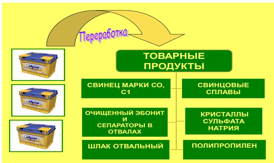
**Рис. 7.** Товарные продукты, полученные при гидрометаллургической переработке отработанных аккумуляторов
