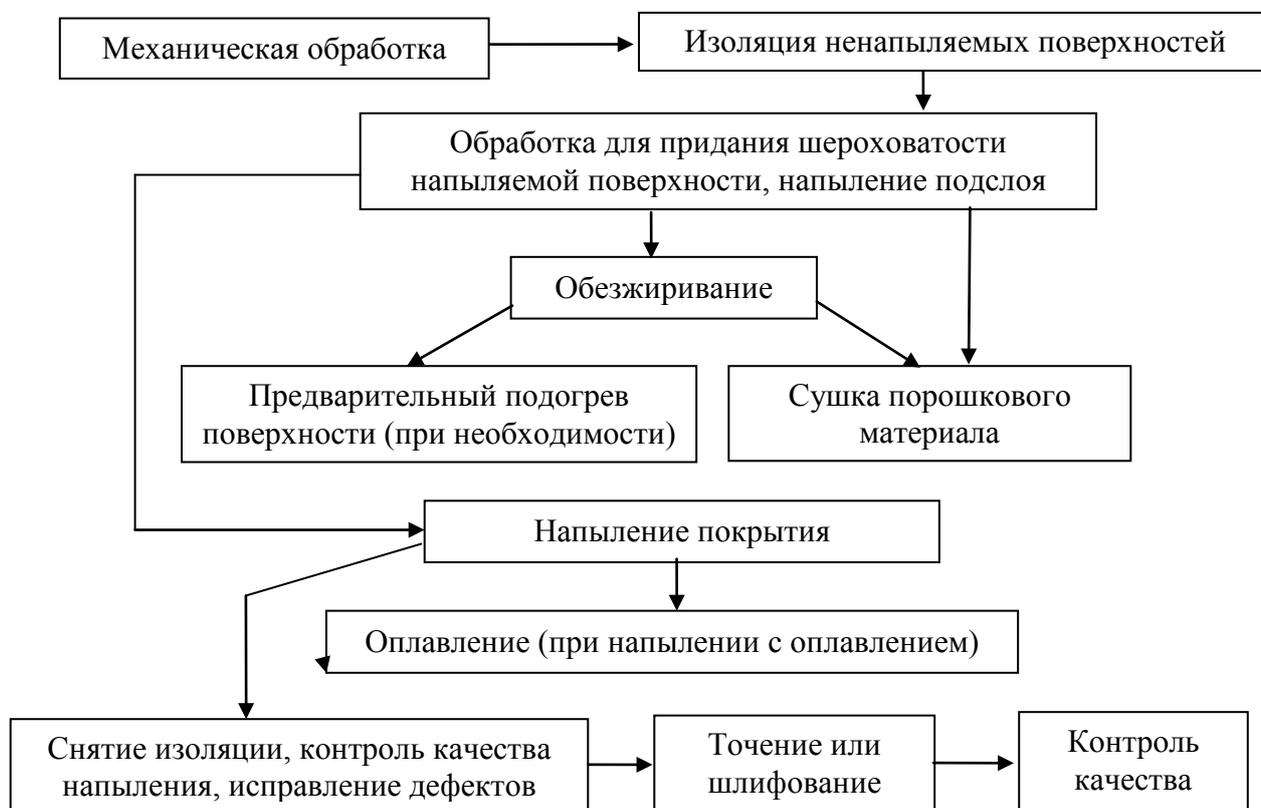
**Рис. 7.** Структура технологического процесса плазменного напыления поверхности
