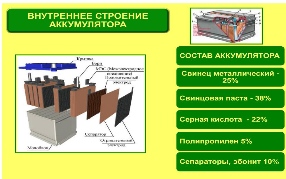
Рис. 2. Внутреннее строение и состав свинцового аккумулятора
