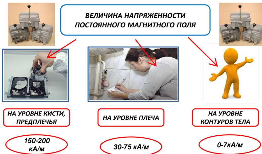
Рис. 9. Результаты измерений величины напряженности постоянного магнитного поля на рабочем месте контролера магнитов
