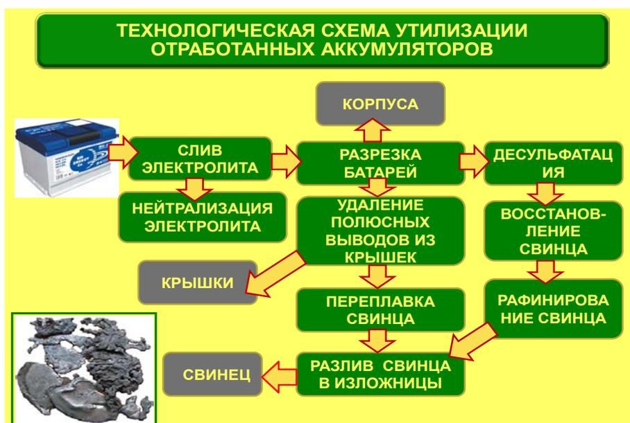
Рис. 6. Технологическая схема утилизации отработанных аккумуляторов
