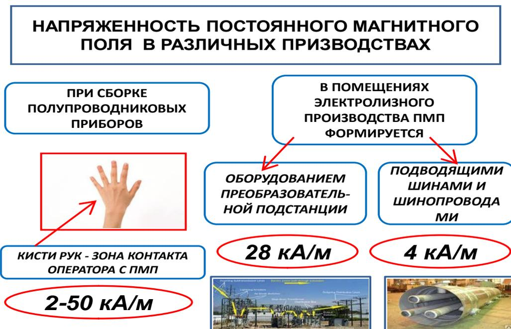
Рис. 10. Напряженность постоянного магнитного поля в различных производствах
