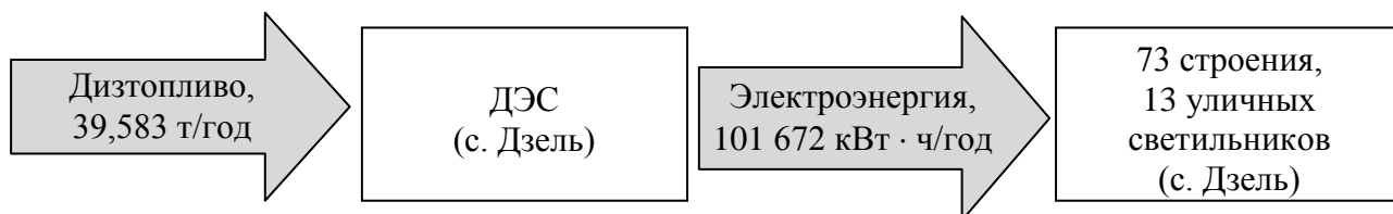
Рис. 2. Электроснабжение с. Дзель (текущая ситуация)
