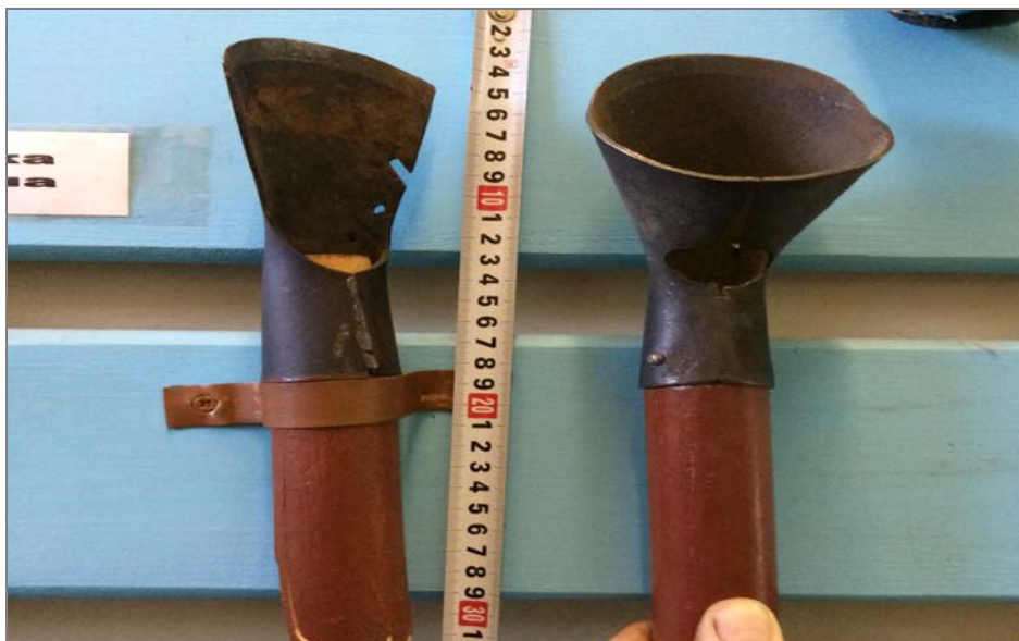
Рис. 3. Стамески для установки приемников способом в «щап»
