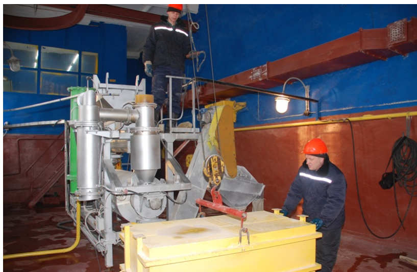
Рис. 1. Установки демеркуризации ртутьсодержащих ламп УРЛ-2М и «Экотром-2»
