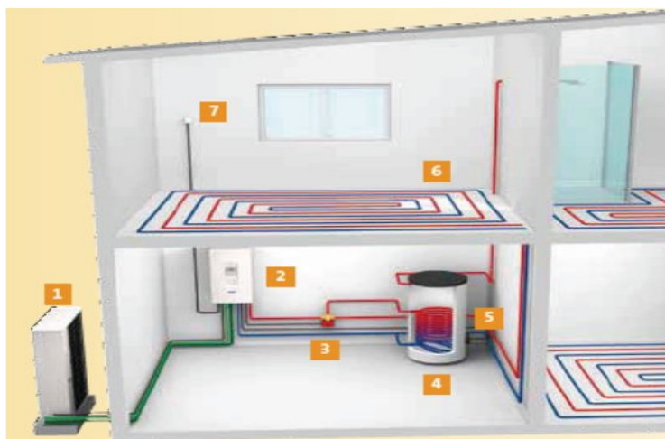
Рис. 6. Схема использования теплового насоса, работающего по схеме «воздух — вода»: 1 — наружный блок теплового насоса; 2 — внутренний блок теплового насоса, нагреватель воды; 3 — трехходовой регулирующий клапан; 4 — ТЭН для дезинфекции ГВС; 5 — бак водонагреватель для горячей воды; 6 — теплый пол; 7 — комнатный термостат
