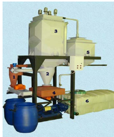
Рис. 1. Установки демеркуризации ртутьсодержащих ламп УРЛ-2М и «Экотром-2»
