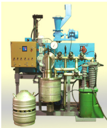
Рис. 1. Установки демеркуризации ртутьсодержащих ламп УРЛ-2М и «Экотром-2»
