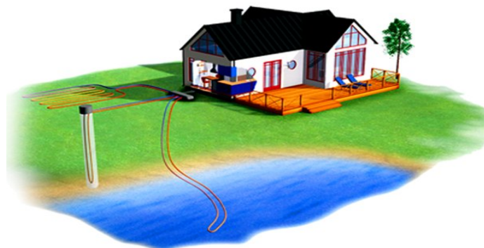
Рис. 4. Схема использования теплового насоса, работающего по схеме «вода — вода»
