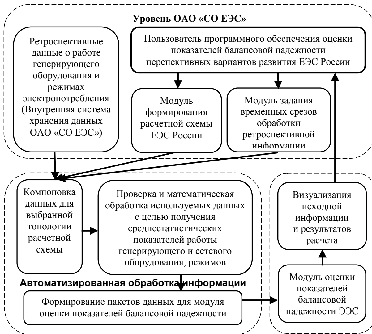
Укрупненная схема взаимосвязи модулей формирования информации и модели оценки показателей балансовой надежности
