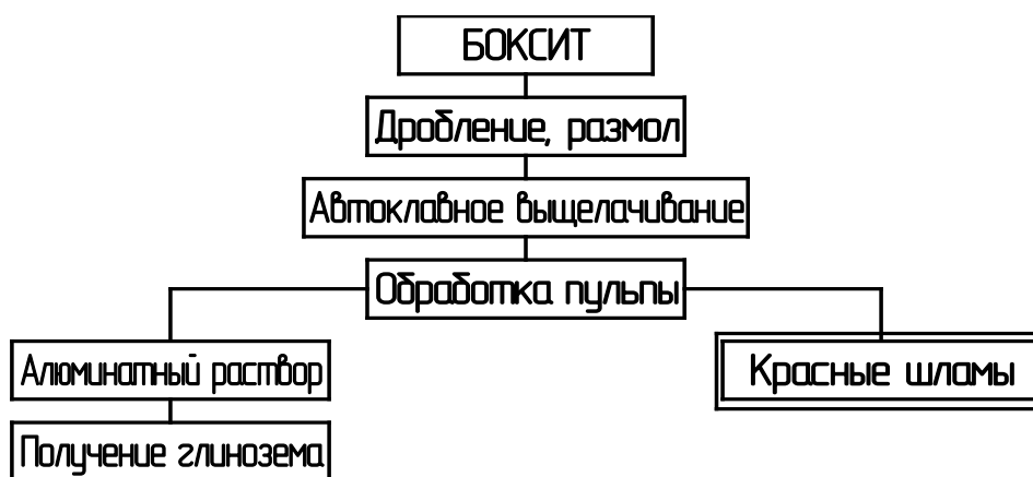
Рис. 1. Упрощенная схема процесса переработки бокситов по способу Байера
