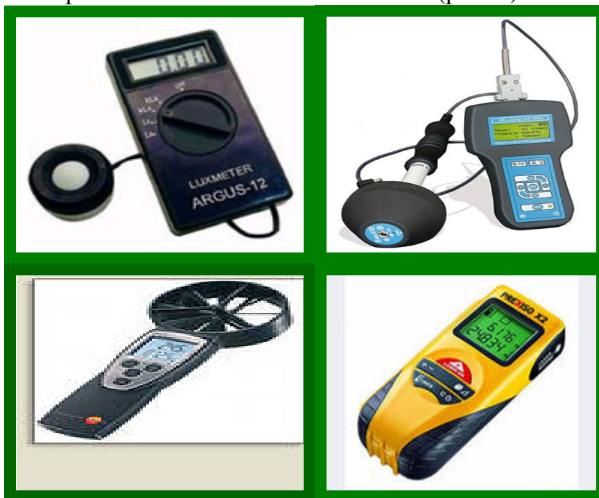
Рис. 2. Приборы, используемые для измерения освещенности и параметров микроклимата: яркомер люксметр АРГУС 12, метеоскоп-М, термоанемометр Testo 417 и дальномер
